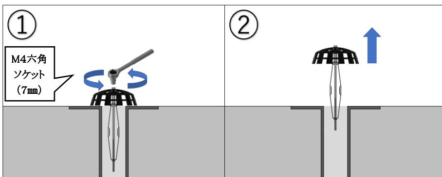
①ソケットレンチを用いて固定金具を緩める（反時計回り）。
