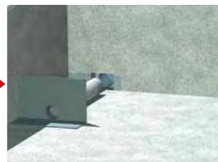
③侍改修ドレンを既設のドレンに差し込み、ハンマー等で叩いて下地に馴染ませます。
