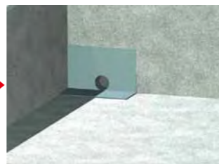
④侍改修ドレン設置後、各種防水層を施工します。
