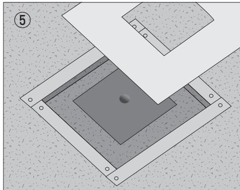
⑤ 塩ビシートを塩ビ鋼板の大きさに合わせて切る。塩ビシートを塩ビ鋼板とドレンには熔融着接合せ、下地へは接着剤を用いて接着させる。
